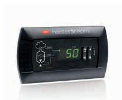
Regeln die Dampfleistung linear von 0 % bis 100 % der Höchstleistung. Sie lassen auch bei häufigen Lüfterneuerungen eine Präzision von  $\pm 1$  %F erzielen. Die Vorwärmfunktion hält das Wasser auf einer zwischen 70 und 90 °C einstellbaren Temperatur; damit kann die Dampfproduktion sofort gestartet werden.
