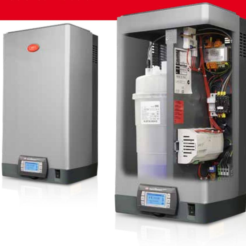
**humiSteam** arbeitet nach einem sehr einfachen physikalischen Prinzip: Normales Leitungswasser enthält eine gewisse Menge an gelösten Mineralien und ist deshalb leicht leitend. Legt man an die ins Wasser getauchten Metallelektroden Spannung an, erhitzt die elektrische Energie das als Widerstand fungierende Wasser bis zur Verdampfung (joulescher Effekt) und erzeugt Dampf.
