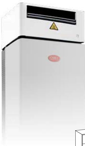
Die **Dampfgebläse** können **direkt auf dem Befeuchter oder entfernt installiert werden**. Im letzteren Fall sind eine Halterung und eine Dampfleitung für den Anschluss des Gebläses an den Befeuchter nötig. Das Dampfgebläse wird im EIN/AUS-Modus betrieben. Eine wärmetechnische Vorrichtung aktiviert es, sobald Dampf produziert wird.
